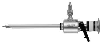
30160 MC Trokar , mit kegelförmiger Spitze, Multifunktionsventil, LUER-Lock-Anschluss, Größe 6 mm, Nutzlänge 10,5 cm, Kennfarbe: schwarz, zur Verwendung mit Instrumenten Größe 5 mm, bestehend aus: 30160 C Trokardorn, mit kegelförmiger Spitze 30160 H2 Trokarhülse, mit Insufflationshahn 30160 M1 Multifunktionsventil, Größe 6 mm
